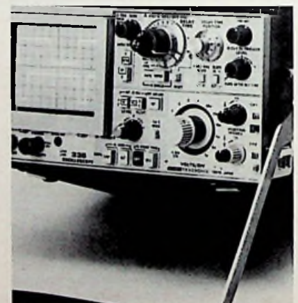
Marke: Tektronix Modell: Zweikanaloszilloskop 335 Nutzbare Schirmfläche: 8 cm x 6,4 cm Vertikal-Grenzfrequenz bei -3 dB: 35 MHz Anstiegszeit der Vertikalverstärker: ≤ 10 ns Vertikal-Koeffizienten: 1 mV/T ... 10 V/T Vertikal-Dehnung: nein Betriebsarten: zerh., abw., Summe, Differenz, XY Signal-Verzögerungsleitung eingebaut: ja Koeff. d. Hauptzeitbasis: 200 ns/T ... 0,5 s/T Dehnung d. Zeitkoeffizienten: 10fach Kompression d. Zeitkoeffizienten: nein Verzögerte Zeitbasis eingebaut: ja Zeitb.-Betriebsarten: verzögert, hellgetastet Triggerquellen: A, B, A+B, extern, Netz Triggerarten: auto, frei, Einzel, +/-, halten Strahlsucher eingebaut: nein Eichquelle eingebaut: ja Gewicht ohne Zubehör: etwa 4,7 kg Preisbeobachtung: etwa 6700 DM
