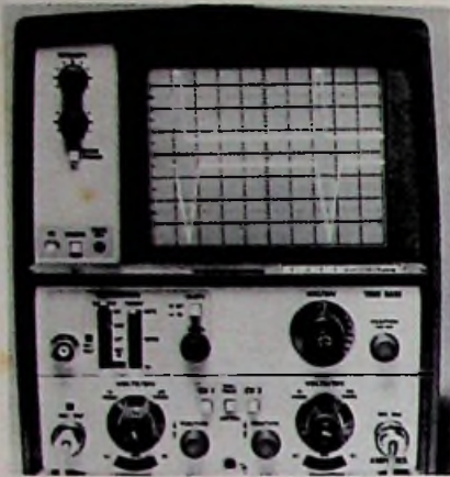
Marke: Tektronix Modell: Zweikanaloszilloskop T 922 Nutzbare Schirmfläche: 10 cm x 8 cm Vertikal-Grenzfrequenz bei -3 dB: 15 MHz Anstiegszeit der Vertikalverstärker: 23 ns Vertikal-Koeffizienten: 2 mV/T ... 10 V/T Vertikal-Dehnung: nein Betriebsarten: zerhackt, abwechselnd, XY Signal-Verzögerungsleitung eingebaut: ja Koeff. d. Hauptzeitbasis: 200 ns/T ... 0,5 s/T Dehnung d. Zeitkoeffizienten: 10fach Kompression d. Zeitkoeffizienten: nein Verzögerte Zeitbasis eingebaut: nein Zeitb.-Betriebsarten: - Triggerquellen: intern, extern, Netz Triggerarten: auto, frei, TV, +/- Strahlsucher eingebaut: ja Eichquelle eingebaut: ja Gewicht ohne Zubehör: etwa 7 kg Preisbeobachtung: etwa 2500 DM mit Tastköpfen
